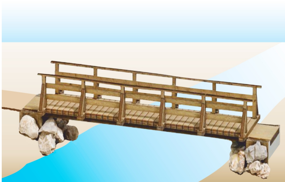
Sistema constructivo bi-apoyado del puente
